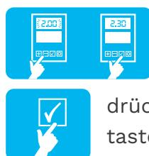
Geben Sie über die + und – Tasten den gewünschten Reifendruck ein (max. 5,5 bar) und drücken Sie dann die Bestätigungs-taste.
